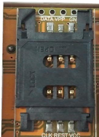
Instale su tarjeta SIM sin forzar el anclaje.
