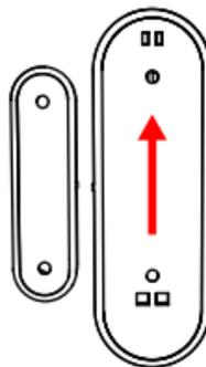
2. Pon la batería en su posición correcta según el esquema interior. Vuelve a cerrar el sensor y observarás como parpadea el led del sensor
